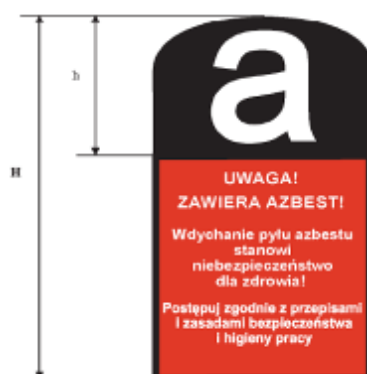
Pomieszczenie zawiera azbest*
