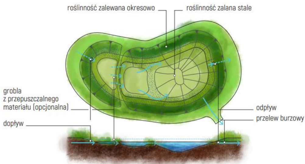
Rysunek 72. Schemat typowego stawu retencyjnego, widok z góry i przekrój.
