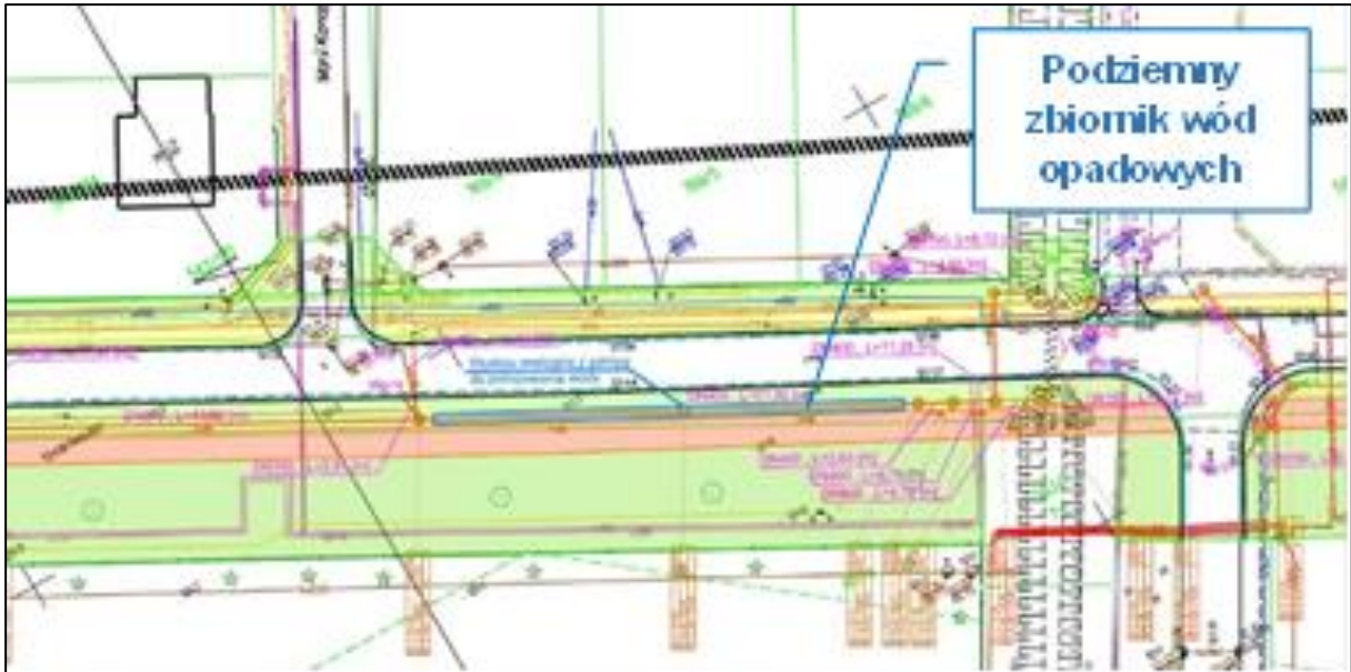
Rysunek 52. Projekt podziemnego zbiornika retencyjnego wód opadowych w pasie zieleni przy ul. Henryka III w Siechnicach.
