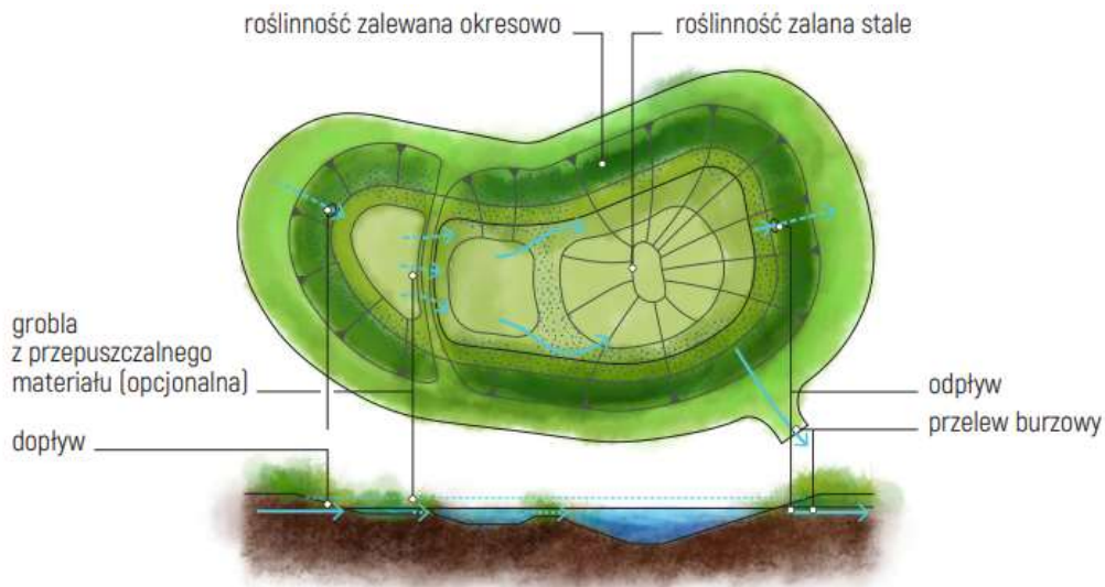
Rysunek 71. Schemat typowego stawu retencyjnego, widok z góry i przekrój.
